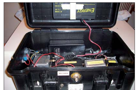
Der FM-Transponder IR1UFB im autarken Koffer Fotos: IZ1DNG
